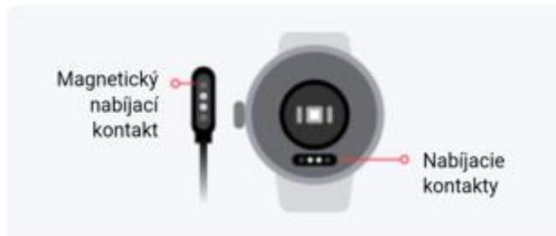
Magnetický nabíjací kábel pripojte na nabíjacie kontakty na zadnej strane hodiniek, aby ste ich nabili. Podržte bočné ovládacie tlačidlo stlačené, aby ste aktivovali a zapli hodinky.
